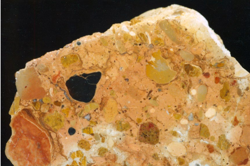
Fig. 24: Anschliff des Krustenkalks an der Basis des OSM-Profiles beim Hof Flühmatt bei Zeglingen (Koord. 2635.090/1251.450). Die mässig bis schlecht gerundeten Gerölle sind z.T. mehrfach umkrustet und zerbrochen. Sandsteingerölle mit Muscheltrümmern könnten aufgearbeitete St.-Gallen-Formation (OMM) bezeugen. Breite der Probe 6,2 cm. Foto H. Winistörfer, 1987.
